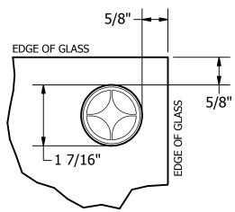
OPERATOR LOCATED IN UPPER LEFT OR UPPER RIGHT CORNER - OPERATOR CANNOT BE MOVED FROM THIS LOCATION
